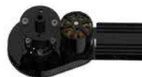
Двигатель с понижающим редуктором
